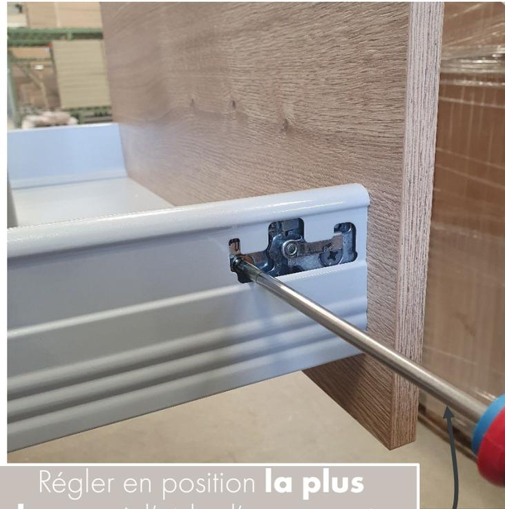
Régler en position **la plus basse**, à l'aide d'un tournevis
